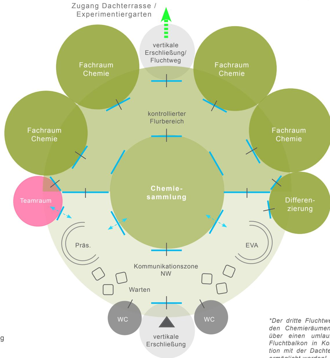
*\*Der dritte Fluchtweg aus den Chemieräumen kann über einen umlaufenden Fluchtbalkon in Kombination mit der Dachterrasse ermöglicht werden!*
